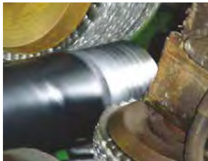
Spazzolatura di una testata di tubo con 2 rulli / Coating removal with 2 perpendicular roller brushes
