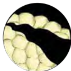
Frattura abrasivo Sol-Gel / Sol-Gel abrasive fracture
