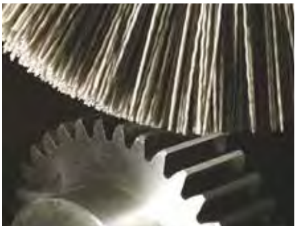
Spazzola in Carburo di Silicio per sbavare ruote dentate / Silicon carbide brush for gear splines deburring
