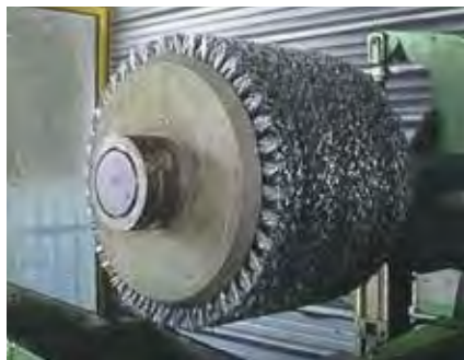
Spazzola a mazzetti ritorti per il cutback / Twisted knot cutback brush
