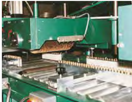
Raspatura del prestampato / Precured tread buffing
